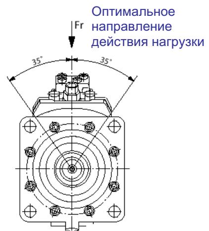
Конструкция фланца по стандарту DIN и в соответствии со стандартом ISO 3019/2
